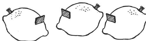
Paso 6. Luego, usando dos cables con pinzas, junta las tres pilas de limón, de manera que el tornillo del primer limón quede unido a través del cable al pedazo de lámina de cobre del segundo limón, y conecta de la misma manera el segundo limón con el tercero.
