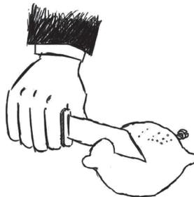
Paso 4. Inserta un pedazo de lámina de cobre dentro del corte para que quede la mitad de ella dentro del limón. Lo creas o no, ¡ahora puedes obtener electricidad de un limón! Esta es una pila de limón que produce electricidad.
