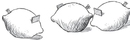
6. Luego, usando dos cables con pinzas, junta las tres pilas de limón, de manera que el tornillo del primer limón quede unido a través del cable al pedazo de lámina de cobre del segundo limón, y conecta de la misma manera el segundo con el tercero.
